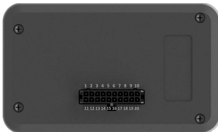
Рисунок 2. Цифровая распиновка разъема внешних подключений.
